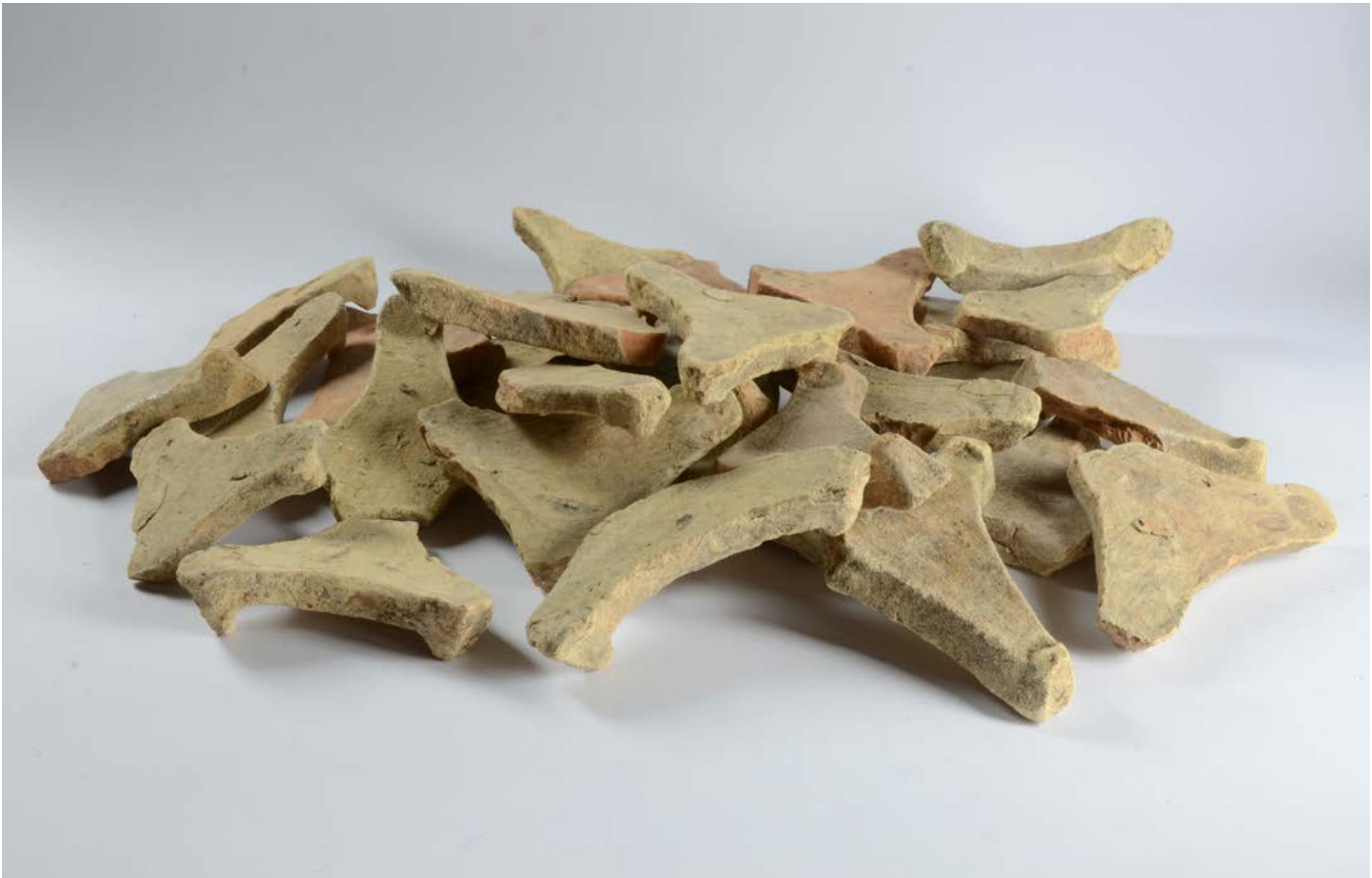
Proenen, afstandhouders die tussen borden worden geplaatst om te voorkomen dat ze aan elkaar bakken. Productieafval van de plateelbakkerij van Severijn Offermans; foto: Archeologie West-Friesland
